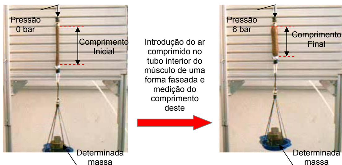
**Figura 29** – Esquema do método utilizado para a obtenção das medições
