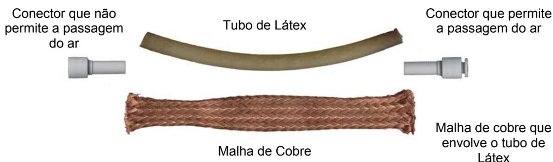
**Figura 26** – Componentes do músculo pneumático
