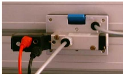
**Figura 56** – Electro-Válvula
