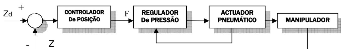
**Figura 47** – Representação esquemática do controlador ideal no espaço dos músculos
